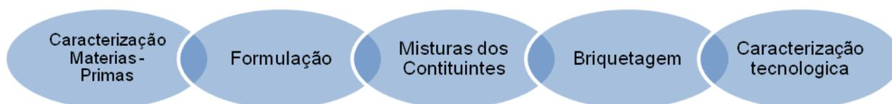
Figura 1: Fluxograma da metodologia de confecção dos briquetes.
