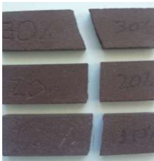
Figura. 5 Imagem mostrando a cor de queima marrom escuro dos corpos de prova queimados a 1120°C.
