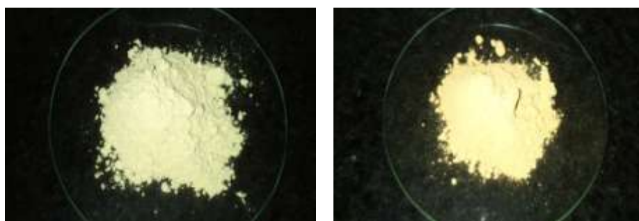
Figura 1 – Argila acidificada (BVA) e acidificada impregnada (BVAI), respectivamente.
