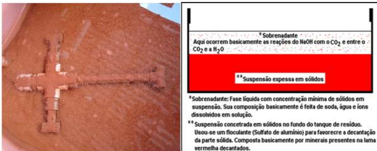
**Figura 2** - Captador no sobrenadante. **Figura 3**- Desenho esquemático do tanque.
