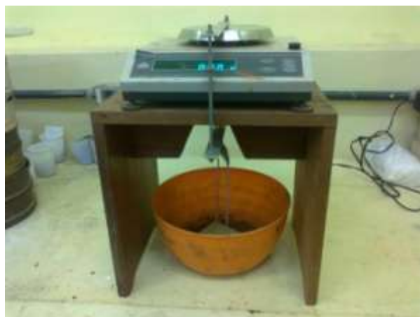
Figura 3- Aparato para obter a massa imersa
