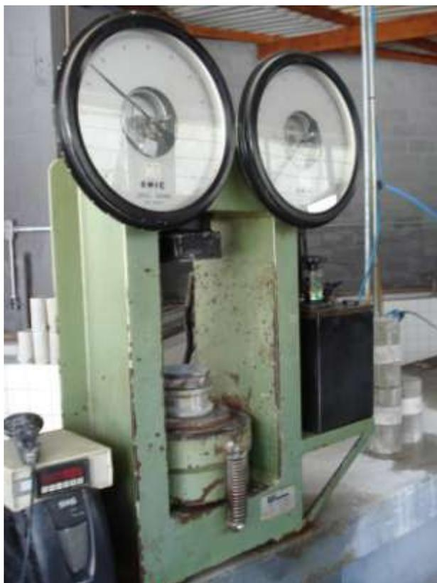
**Figura 2:** Prensa hidráulica para ensaio de compressão.
