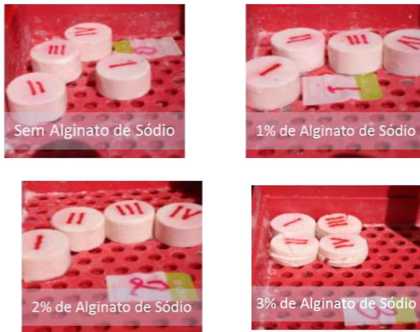
Figura 2 - Peças prototipadas em impressora 3D mantidas a 100% de umidade relativa por 1 dia.
