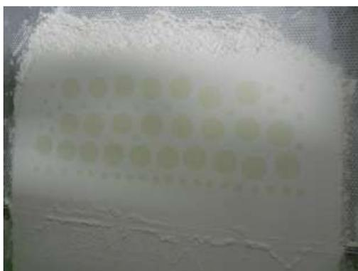
Figura 1 - Foto de uma camada aspergida nos locais das peças.
