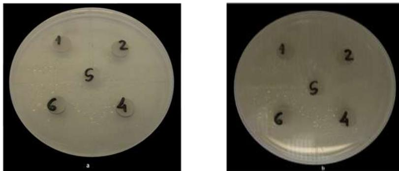
Figura 1: Fotos das placas de (a) ágar Mueller Hinton (Himedia) ou (b) ágar Sabouraud-dextrose (Himedia), para *C. albicans*; contendo as pastilhas de cimento sem Ag (s) e com diferentes teores de prata (1, 2, 4 e 6%-p).
