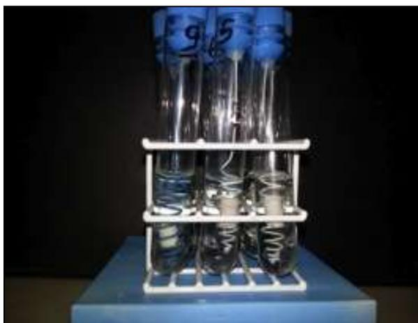
Figura 2. Corpos de prova imersos em solução – início dos testes *in vitro*.
