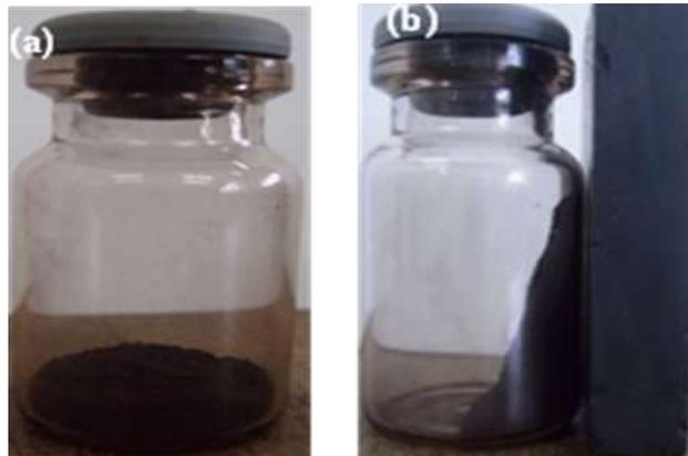
**Figura 3** – Comportamento magnético com o ímã do tipo ferrite para as amostras: (a)  $\text{CoFe}_2\text{O}_4$  sem a presença do ímã e (b)  $\text{CoFe}_2\text{O}_4$  na presença do ímã.
