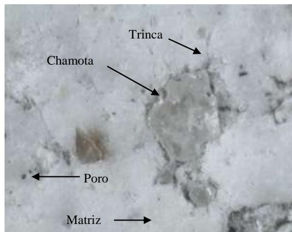
Figura 5. Imagem da superfície do refratário F sinterizado a 1400°C.
