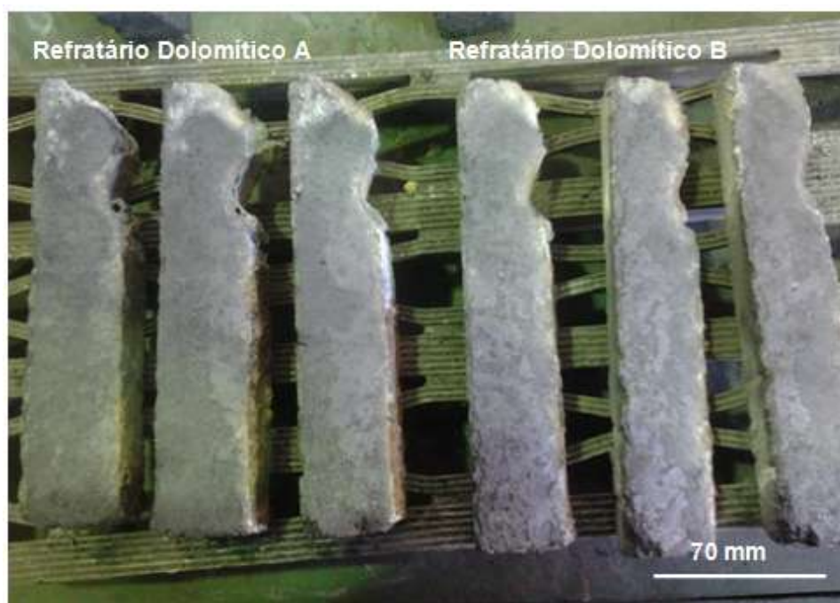
Figura 2: Região desgastada do corpo de prova em contato com a escória durante ensaio.
