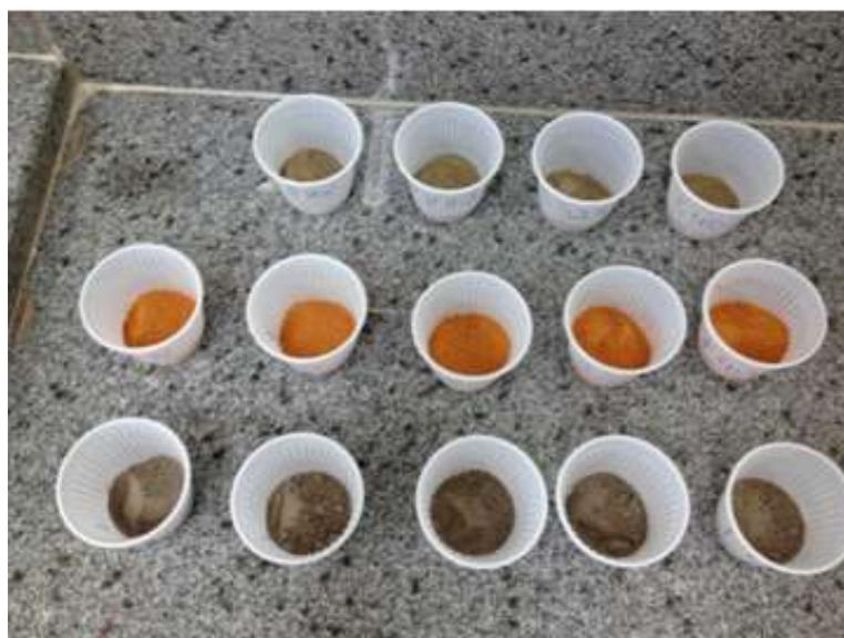
**Figura 02.** Material separado para fazer os ensaios de pozolanicidade.
