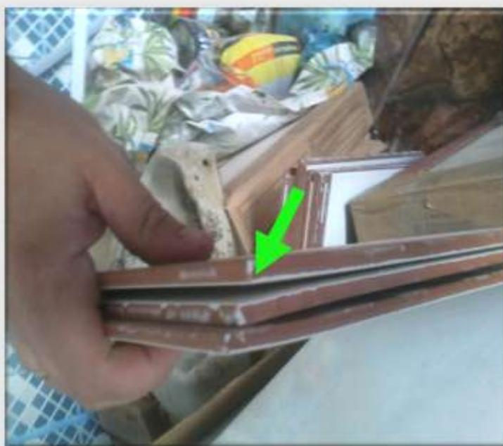
Figura 8 – Placas cerâmicas com empeno
