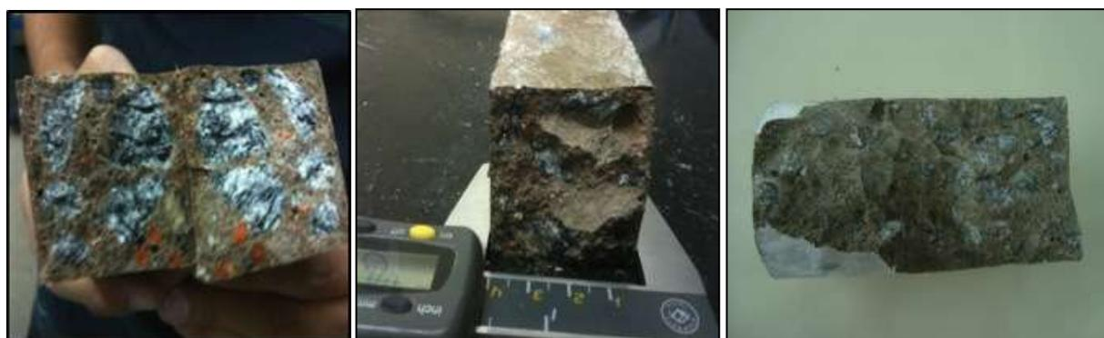
Figura 3: Análise da superfície de fratura dos corpos-de-prova.
