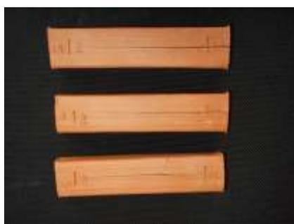
*Figura 7 - corpos de prova queimados a 650, 700 e 750°C com trincas*
