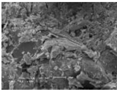
Fig. 11: Micrografia de MEV da AM 02 a 850°C, 1000x.
