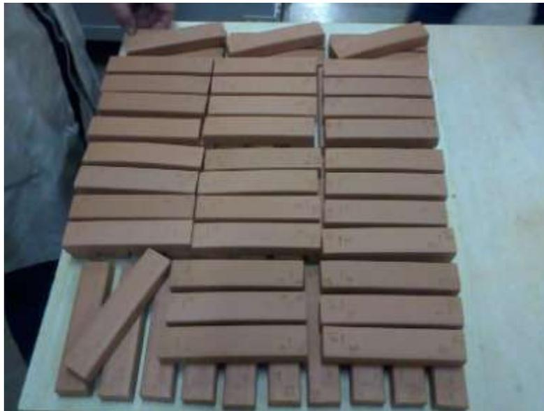
Figura 2 – Corpos de prova obtidos por extrusão
