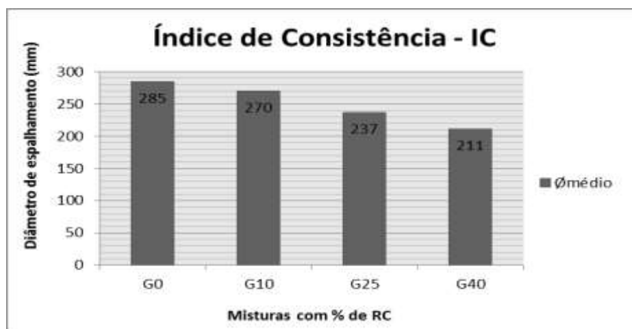
Fig. 1 – Gráfico indicando o índice de consistência das argamassas analisadas.
