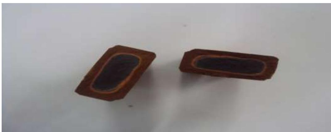
Figura 1 – Presença de coração negro em corpo de prova de cerâmica vermelha.
