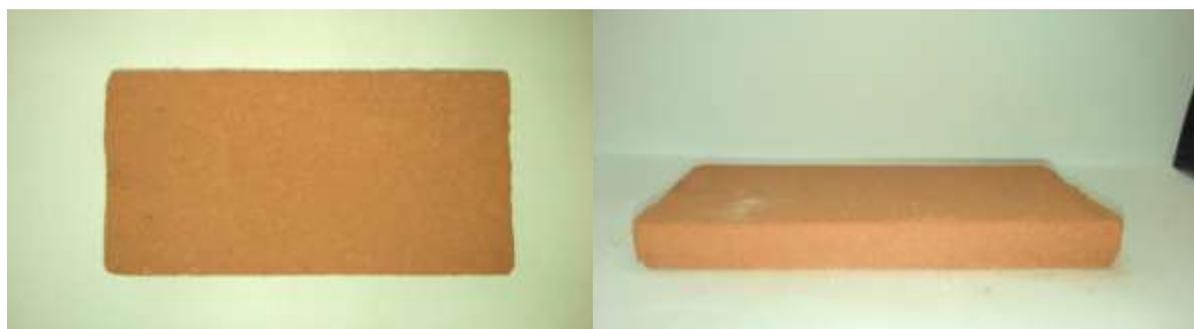
**Fotografia 3** – Material sinterizado a 1100°C
