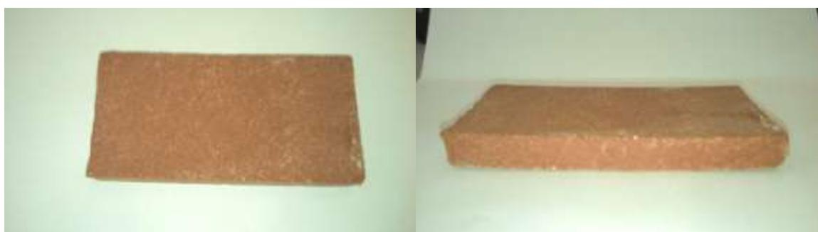
**Fotografia 4** – Material sinterizado a 1200°C
