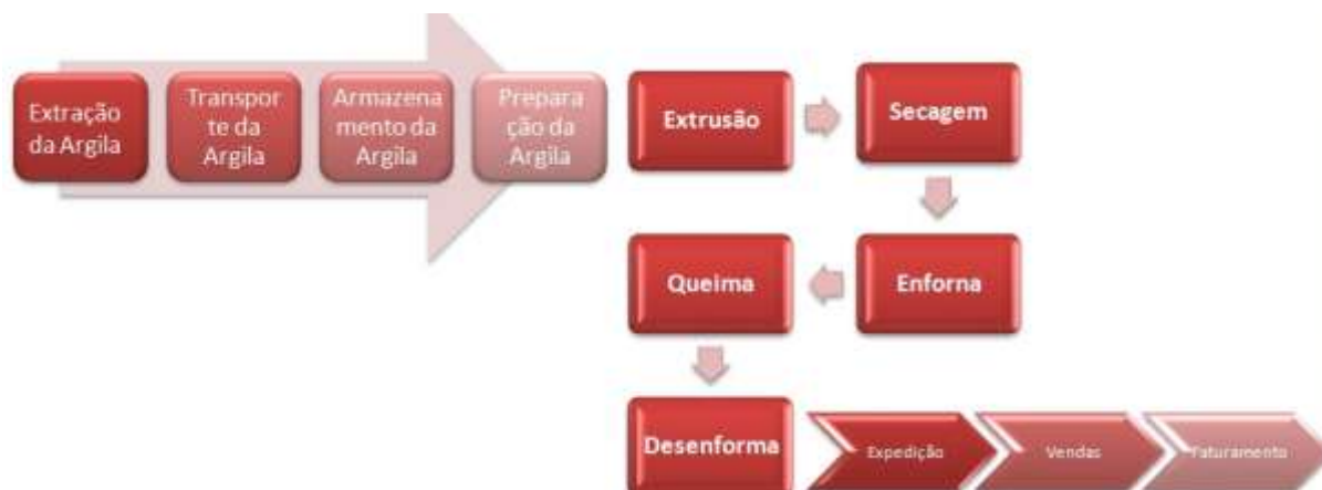
Figura 1 - Fluxograma do processo de fabricação de tijolo
