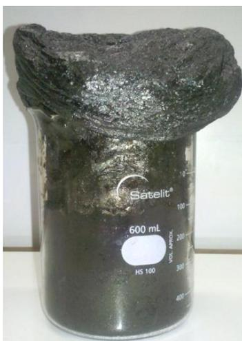
Figura 1. Espuma resultante da queima do gel obtido pelo método Pechini.
