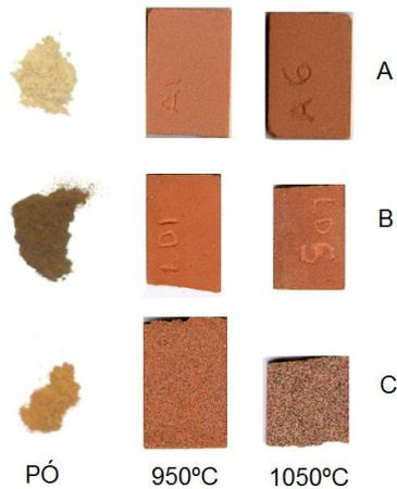
Figura 2. Aspecto das matérias-primas. A) Argila. B) Lodo de esgoto. C) Lama vermelha.
