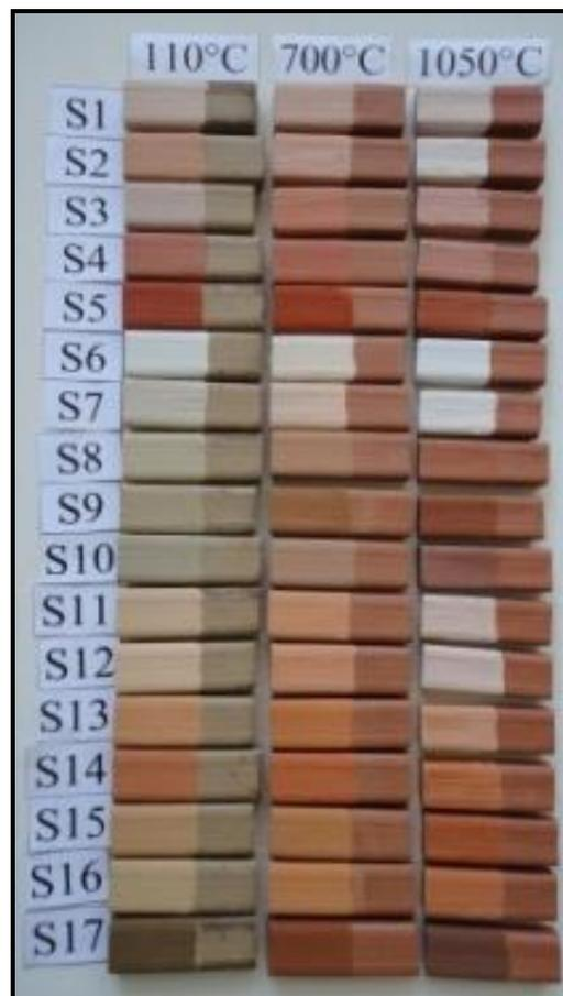
**Figura 1:** Corpos de prova pintados com engobes passados na peneira #200, antes e após a queima.
