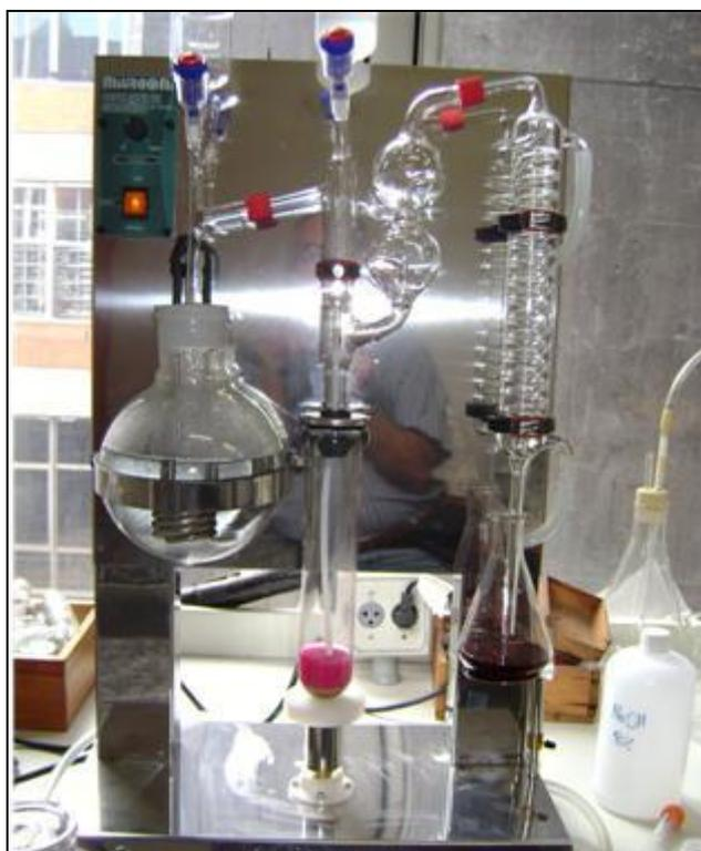
Figura 2. Determinação da capacidade de troca de cátions.
