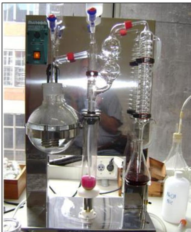
Figura 1. Determinação da capacidade de troca de cátions.
