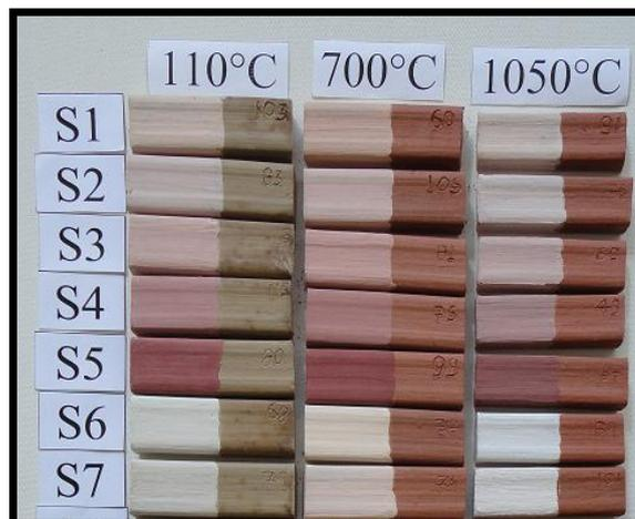
**Figura 6** - Corpos de prova pintados com engobes, que foram passados nas peneiras # 200, antes (110°C) e após a queima (700-1050°C).
