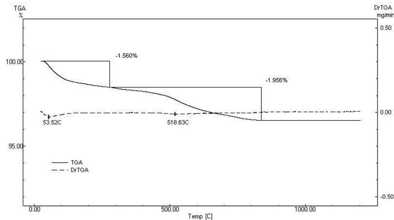
Figura 2: Curva termogravimétrica (TGA) da argila.
