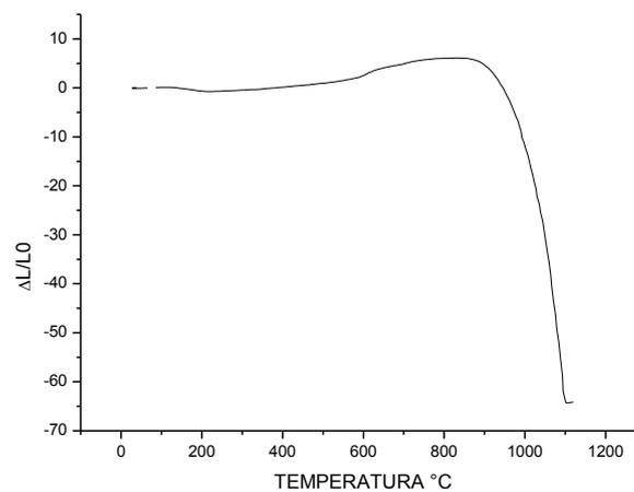
Figura 4: Curva dilatométrica da argila.
