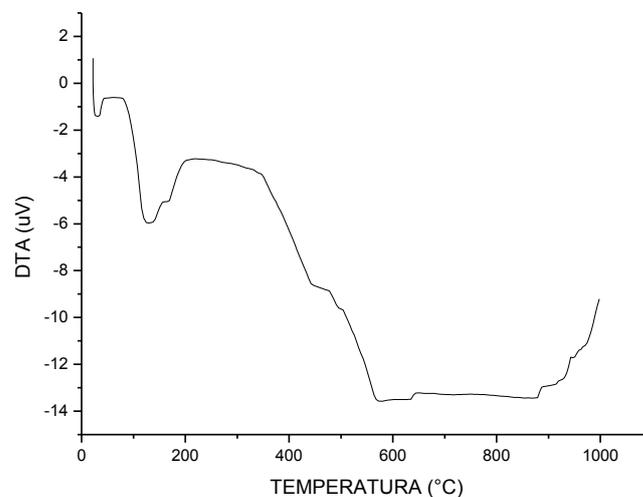
Figura 3: Curva termodiferencial (DTA) da argila.
