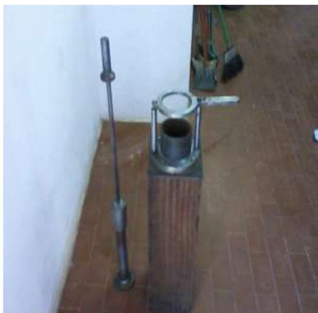
Figura 1: Molde e soquete para compactação do corpo-de-prova
