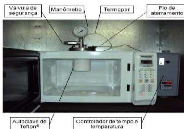
**Figura 2:** Forno microondas adaptado para a síntese por MAH.
