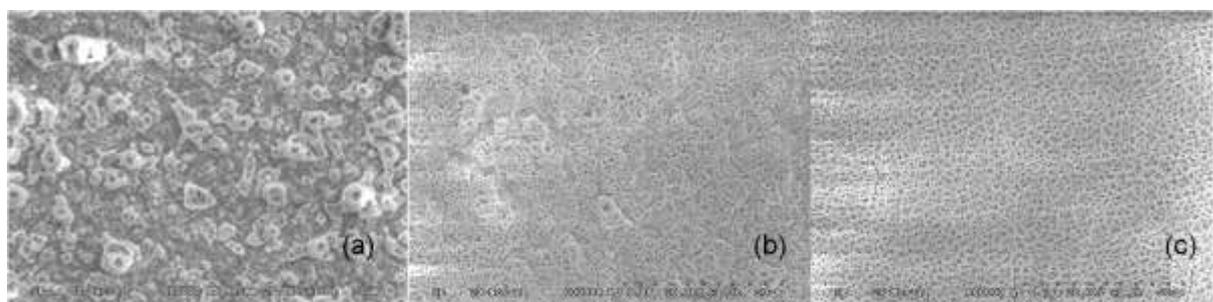
Figura 3: Filmes depositados por spray pirólise com os substratos pré-aquecidos a 500°C usando água como solvente: (a) filme sobre anodo; (b) filme sobre anodo polido; (c) lamínula de vidro.
