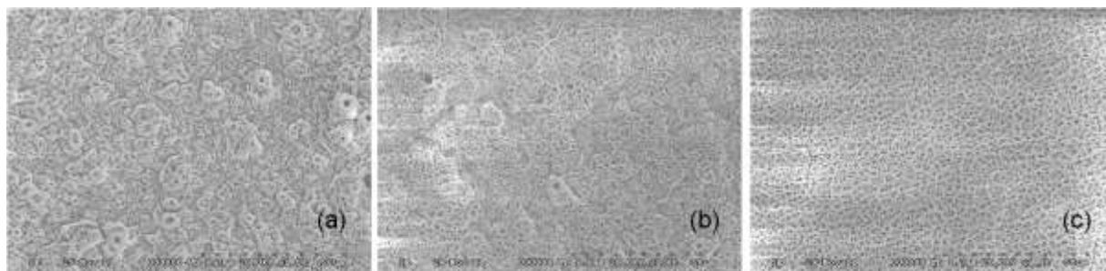
Figura 2: Filmes depositados por spray pirólise com os substratos pré-aquecidos a 400°C usando água como solvente: (a) filme sobre anodo; (b) filme sobre anodo polido; (c) lamínula de vidro.
