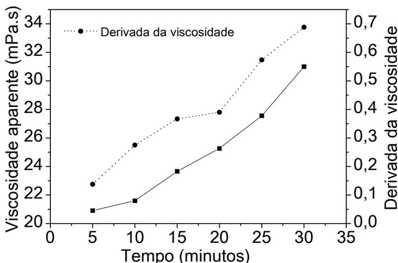
**Figura 5:** Variação da viscosidade aparente com o tempo de homogeneização, comparada com a derivada da viscosidade em função do tempo.
