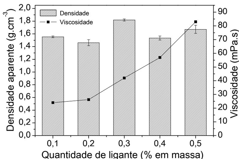
**Figura 6:** Densidade aparente a verde e variação da viscosidade aparente da suspensão com 40% de sólidos (LZSA) e 2% de PAA com a variação do teor de ligante (PVA).
