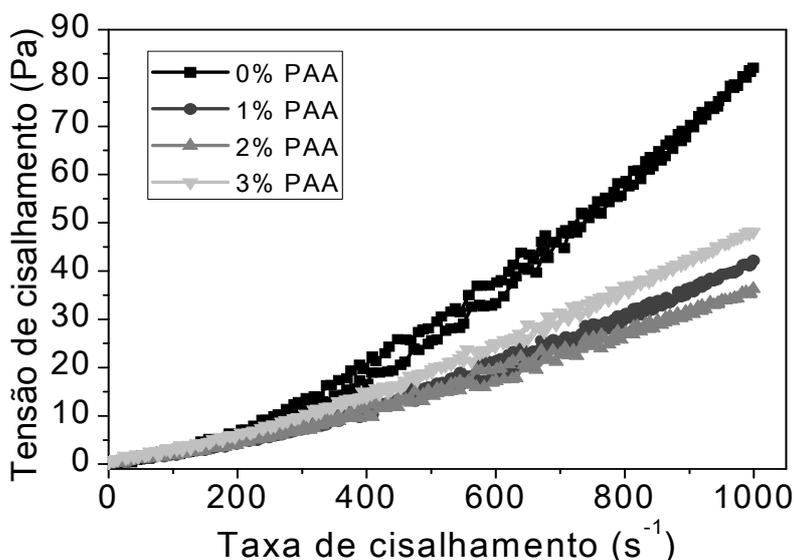
**Figura 4:** Curvas de fluxo para suspensão com 40% de precursor vitrocerâmico LZSA contendo diferentes frações mássicas de dispersante (PAA).
