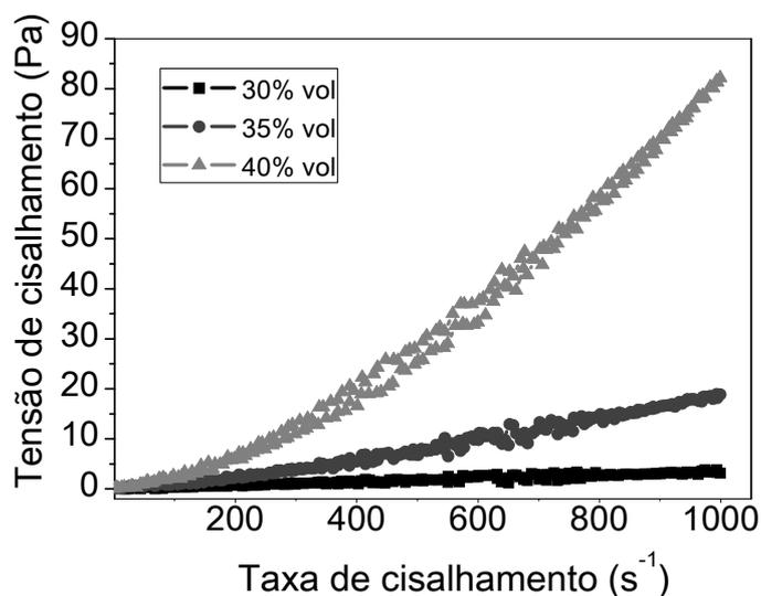
**Figura 2:** Curvas de fluxo para suspensões de LZSA contendo diferentes concentrações de sólidos.
