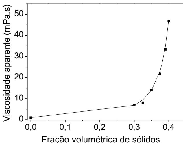
**Figura 1:** Variação da viscosidade aparente em função da fração volumétrica de sólidos das suspensões.
