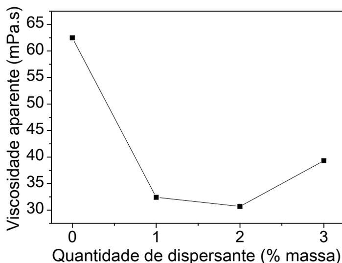
**Figura 3:** Variação da viscosidade aparente da suspensão com 40% de sólidos em função da quantidade dispersante.
