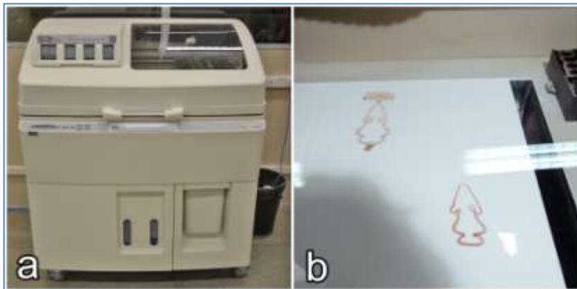
**Figura 9** - Impressora 3D modelo Z 510 da Z Corporation. A figura b mostra uma das camadas da região do nariz sendo impressa.
