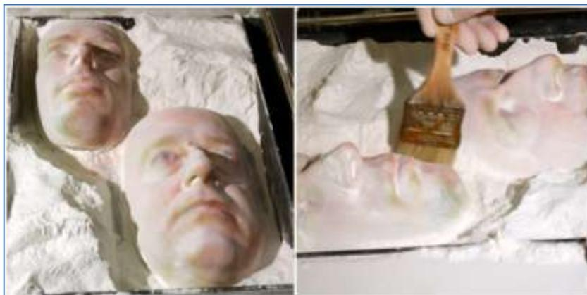
**Figura 10** - Peças sendo retiradas do leito de construção
