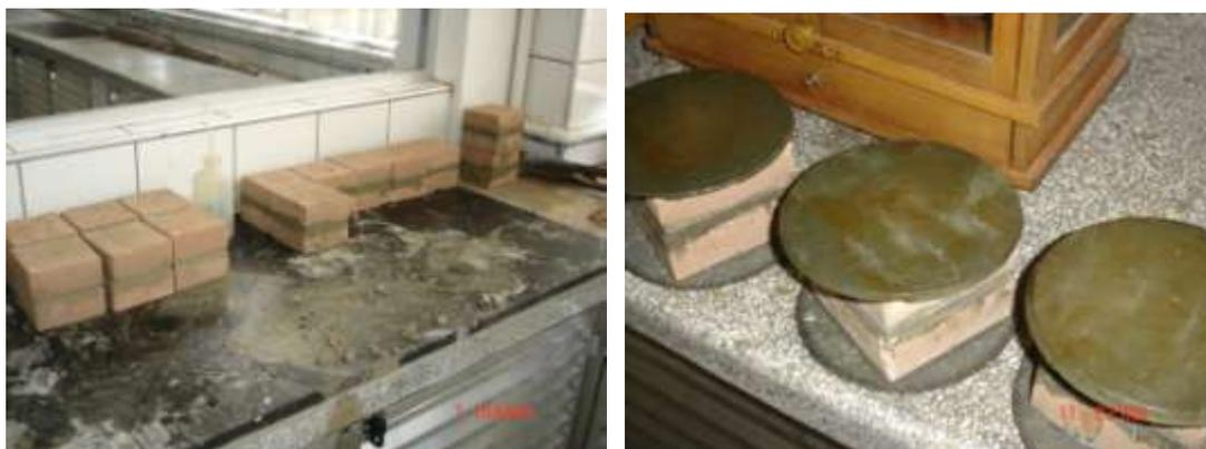
**Figura 2:** Tijolos assentados com a argamassa (esq.) e capeados com enxofre (dir).
