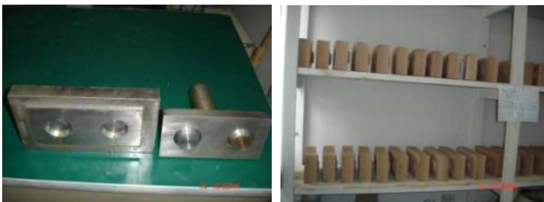
**Figura 1:** Peça superior e inferior da matriz e tijolos modulares secando (28 d).
