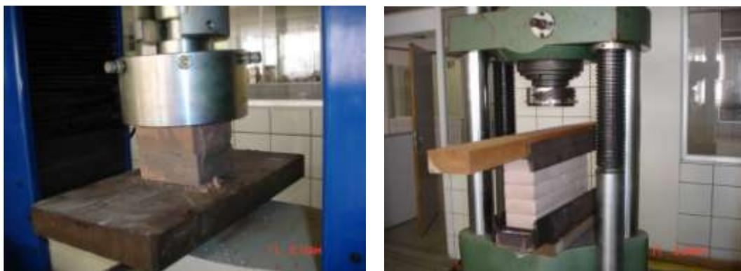
**Figura 3:** Ensaio de tijolo e da parede de tijolos modulares assentados a seco.
