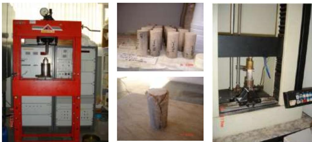
**Figura 4:** Prensa hidráulica com matriz para corpos de provas cilíndricos (esquerda), CPs, CP rompido (centro) e máquina de ensaio EMIC – 2000 (direita).
