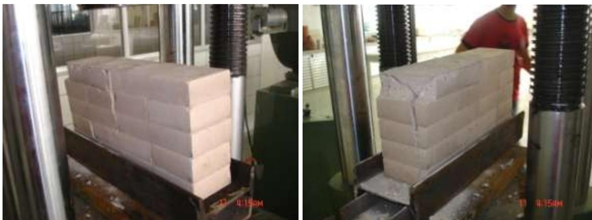
**Figura 6:** Ruptura do painel de alvenaria.
