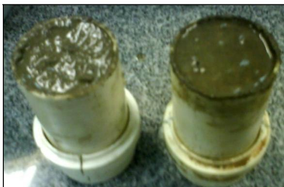
**Figura 2:** Moldes dos corpos de prova de argamassa com 10% e 30% de resíduos de EVA com granulometria maior que 3,35 mm incorporados como substitutos parciais da areia.
