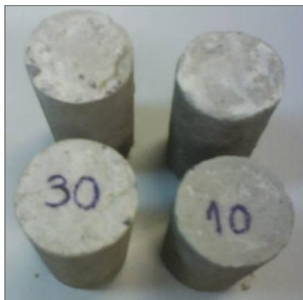
**Figura 8:** Corpos de prova com resíduos de EVA maiores que 3,35 mm em substituição aos agregados finos em 10% e 30%.
