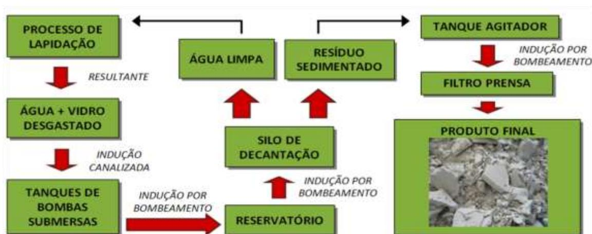
Figura 01 – Fluxograma do percurso da água utilizada no processo de lapidação das chapas de vidro e da obtenção do resíduo de ETE.
