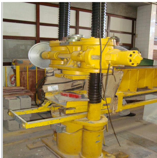
Figura 3 – Equipamento AMSLER utilizado para ensaios de resistência a compressão.
