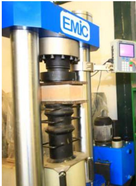
Figura 6 – Ensaio de resistência à compressão dos tijolos.
