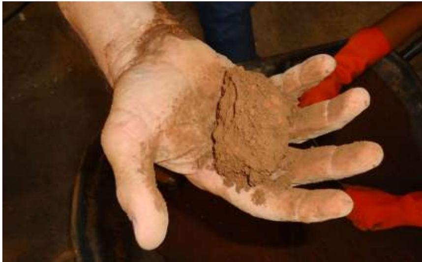
Figura 3 – Determinação da umidade ótima por meio de teste táctil visual.
