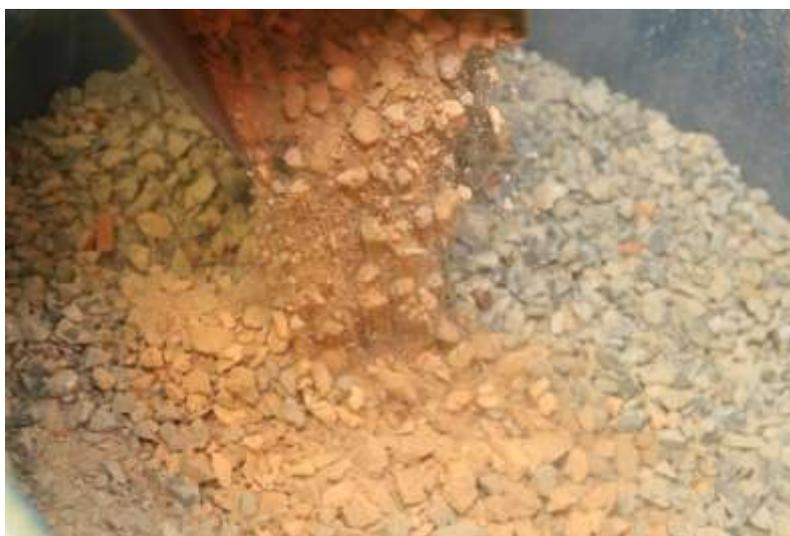
Figura 1 - Resíduo de Construção e Demolição após britagem.
