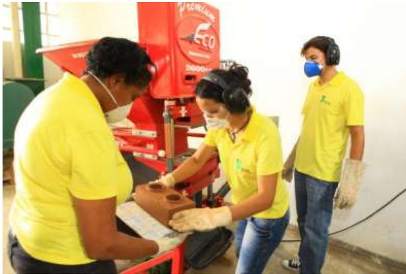
Figura 4 – Moldagem dos tijolos em prensa hidráulica.
