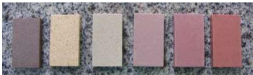
Figura 5. Corpos-de-prova queimados: 1500, 1400, 1300, 1200, 1100, 1000°C (da direita para a esquerda).
