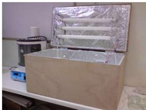
**Figura 2.** Reator de foto-Fenton utilizado.
