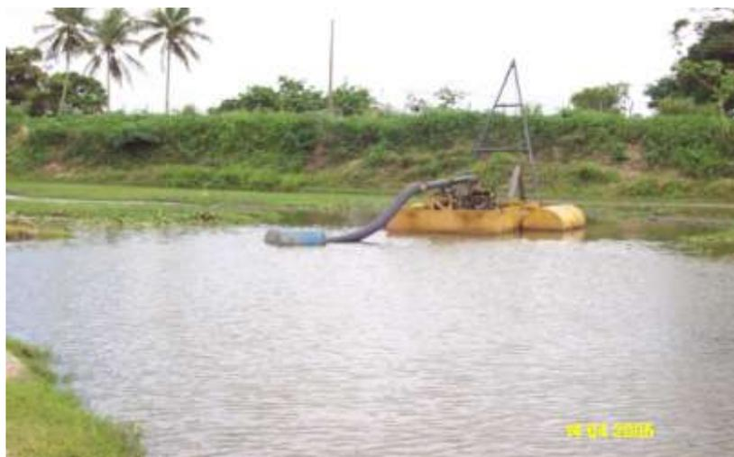
**Figura 2** – Dragagem executando a extração da areia no leito móvel do rio.
