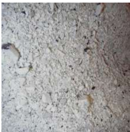
Figura 2. RCV após processo de fragmentação.
