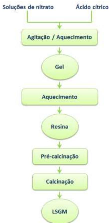
Figura 1: Fluxograma da sequência experimental do método de complexação de cátions.
