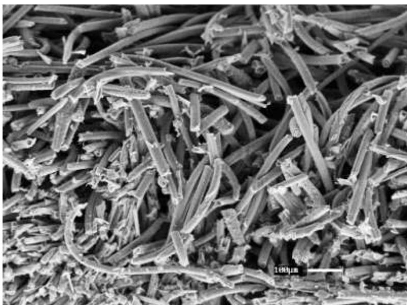
Figura 2 – Região da peça densificada com hexano.
