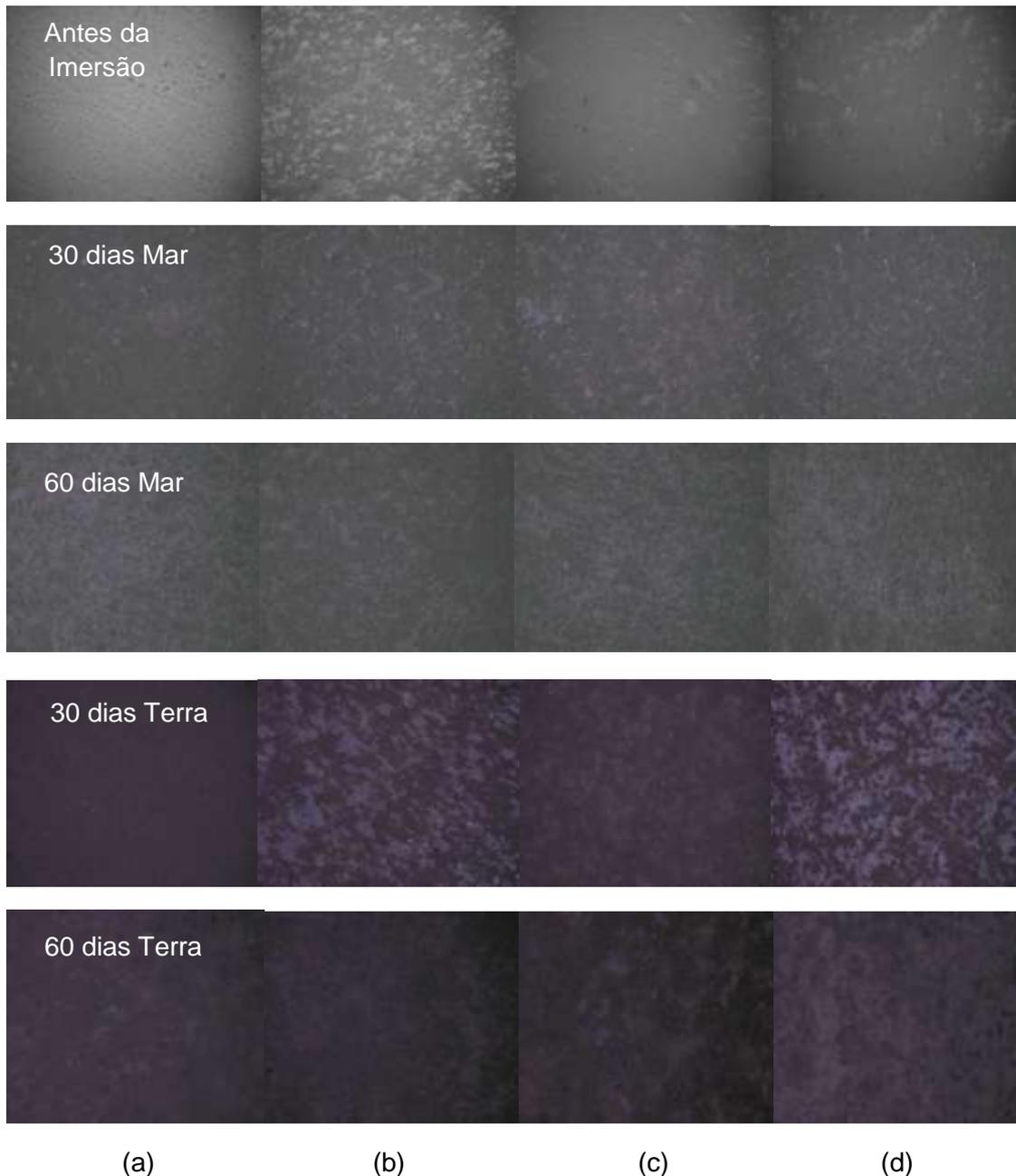
Figura 7: Microscopia óptica (x100) antes e depois da imersão em petróleo sergipano de mar e de terra (a) 5 wt% TiO<sub>2</sub>, (b) 10% em peso de TiO<sub>2</sub>, (c) 15% em peso de TiO<sub>2</sub>, (d) 20 wt% TiO<sub>2</sub>.
