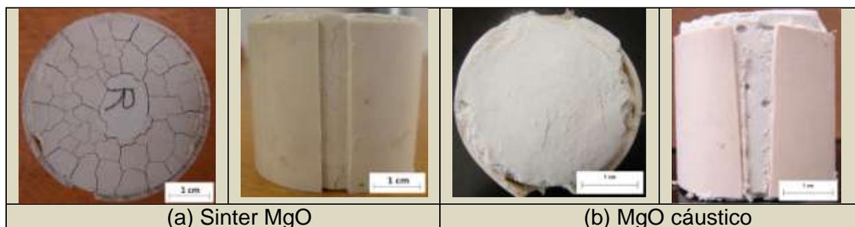
Figura 3. Imagem após expansão do MgO. a) sínter de MgO b) MgO cáustico.
