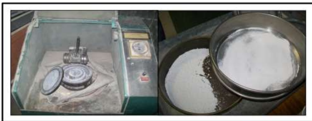
Figura 2 – Moinho de argolas e resíduo de vidro laminado após processo de moagem
