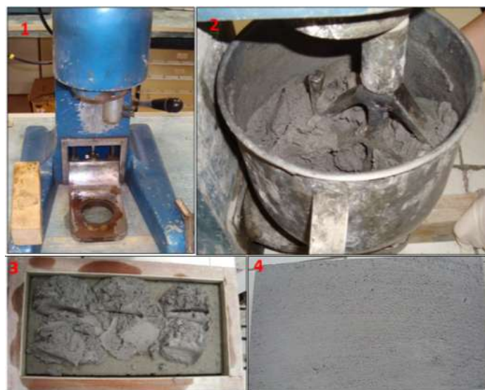
Figura 5 - Confecção das argamassas: 1 - Argamassadeira; 2 - mistura dos materiais; 3 - argamassa sendo moldada; 4 - amostra finalizada.
