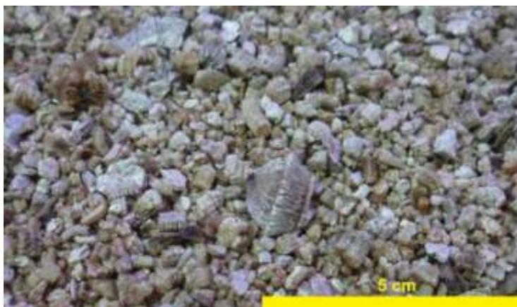
**Figura 1.** Morfologia da vermiculita, mostrando heterogeneidade dos grânulos.
